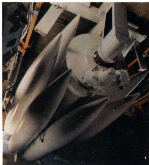
美国B-52G型战略轰炸机弹舱内 装挂的8枚战略导弹
