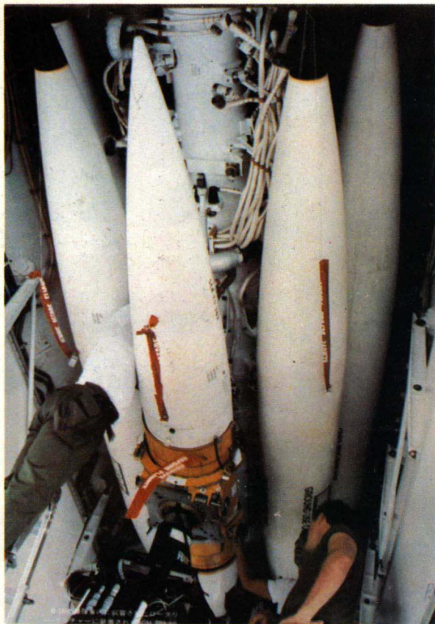
装载在美国B-1B战略轰炸机上的 AGM-69A空中发射巡航导弹
