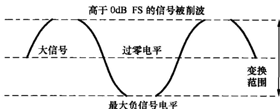
图1-10 数字系统中超过峰值点电平的信号被削波情况
