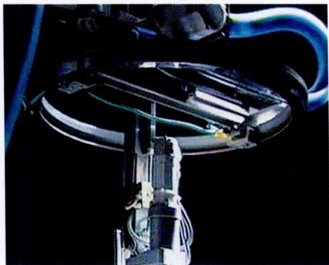
图1-3-3 固定在悬圆盘式底座上的第三代主动定向机器人
