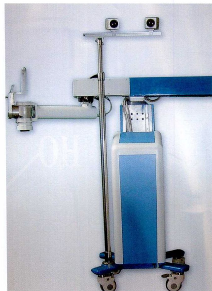
图 1-3-5 增加了视觉检测定位装置的第五代主动定向机器人
