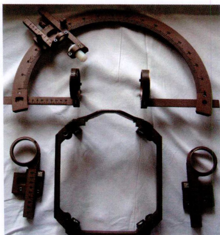
图 1-2-9 国产 HB-4 立体定向仪 (基环-立柱式)
