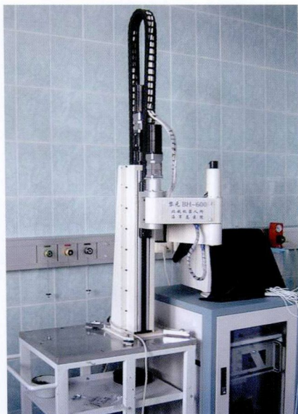
图 1-3-4 固定在旁立拉杆式底座上的第四代主动定向机器人
