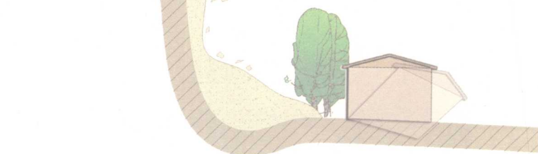
(b) 泥石流引起的建筑破坏
