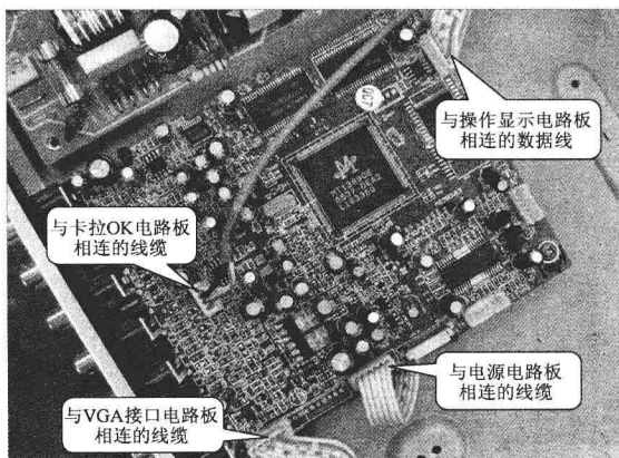
图 1-17 连接数字信号处理电路板的线缆
