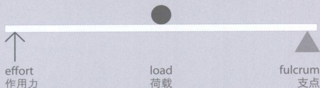
second class lever 第二型杠杆
