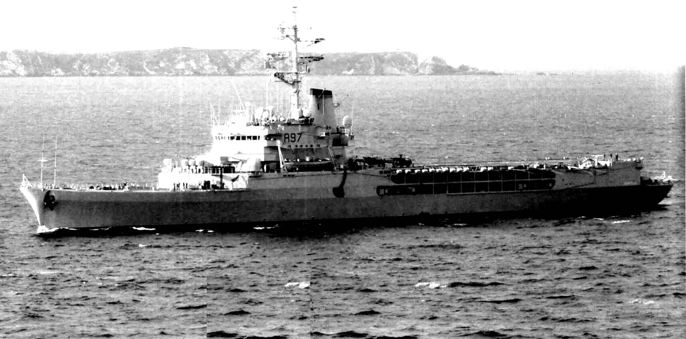
直升机巡洋舰“贞德”号（Jeanne d'Arc）于1964年建成，堪称搭载直升机的多用途舰之先驱。舰龄虽然已达到45年，但仍在服役，平时仅搭载少量直升机，担任官校学员的训练舰。战时则可充当反潜直升机母舰、突击登陆母舰或者指挥舰。最初的装备仅有舰炮，在1976年搭载了6具“飞鱼”反舰导弹单装发射筒。照片拍摄于2008年。
