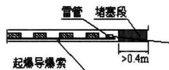
图2 周边光面爆破孔装药结构
