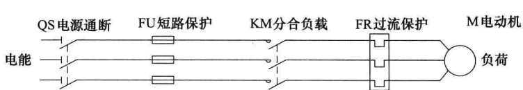
图 1-2 电路中元件的功能
