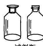
试剂瓶 | 玻璃质,有磨口和非磨口,无色和棕色之分,按容量分有100,250(mL)等 | 储存溶液或存放液体药品                  | (1)不能加热<br>(2)易见光分解的或不稳定的液体药品应放在棕色瓶中<br>(3)瓶塞分为橡皮塞和玻璃塞,存放碱液应选用橡皮塞  |
