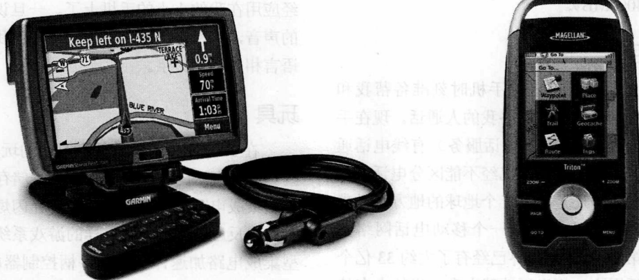
图1-3：在使用GPS接收机前，我们是怎么找到路的呢？型号为Garmin街道领航员7200的导航仪是为汽车使用而设计的，用以显示地图和行驶线路，并从点烟器插孔供电。电池供电的手持式导航仪，如型号为麦哲伦海之星的导航仪，深受远足等户外爱好者的欢迎。
