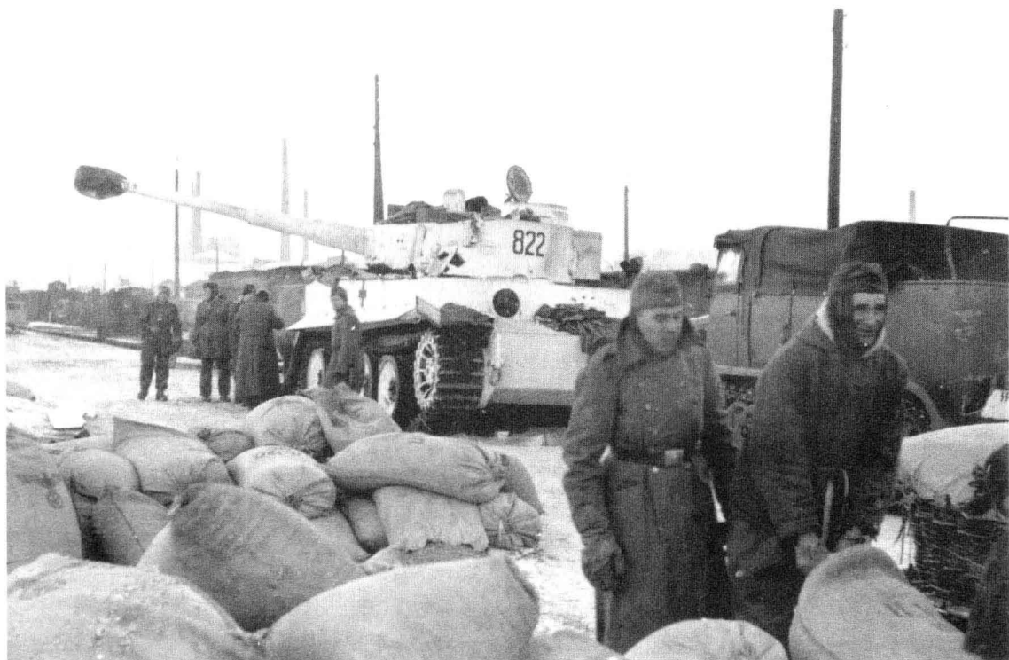
▲ 刚刚从哈尔科夫卸车的“帝国”师下属第8重装甲连的“822”号虎式坦克，注意它仍然使用的是运输型履带（窄型）。
