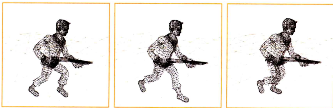
图1.5 通过控制骨骼结构可实现多边形网格的动画效果
