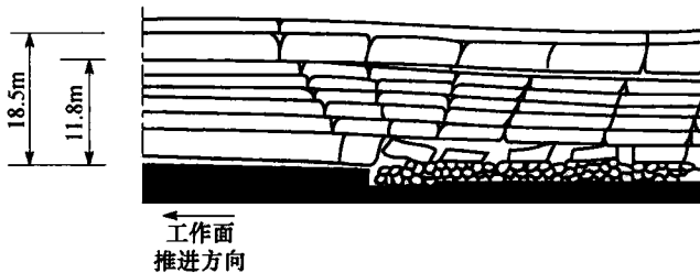
图 1.4 采动过程中顶板裂隙分布
