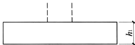
图 2.3.2-2 单阶普通独立基础竖向尺寸
