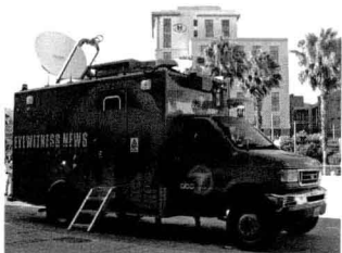
电子现场摄制方式是小型可移动的电视制作系统, 图为移动直播车, 此为现代电子现场摄制的一个典型标志。
