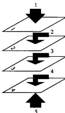
过孔要实现电路的互连，它自身就必须导电，这是通过在过孔的柱状内壁上镀铜来实现的。从过孔的结构上看，它实际上就是一段垂直的柱面状导线。过孔如果导电不良，就会导致信号无法传输，这是直接关系到主板质量的重要因素。
