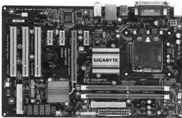
要将主板从机箱中取出，除了要卸掉将主板固定在机箱上的螺钉外，还需要将连接在主板上的各种连接线（机箱前置 USB 连接线、开机复位连接线、系统/硬盘指示灯连接线、机箱前置麦克/耳机连接线、风扇连接线等）、扩展卡（独立的声卡、网卡、调制解调器、独立的显卡等）拔出，再将 CPU、内存从 CPU 接口和内存接口中取出，主板就成了一块裸板。
