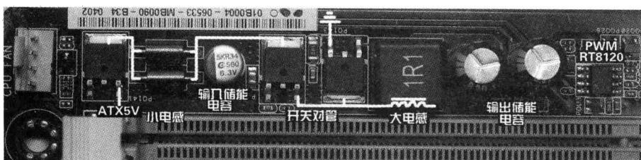
在双电感电路中，体积较小的小电感一定是该开关电源的电能输入端；体积较大的大电感的直流侧一定是该开关电源的电能输出端。开关电源的供电管一定是双场管的形式。双场管指的是供电管的功能而非数量。一般用上/下管或高/低端门场管来对其功能进行命名。通常情况下，会使用一个场管作为上管和一个场管作为下管。当然也可以同时使用两个场管作为上管或同时使用两个场管作为下管。
