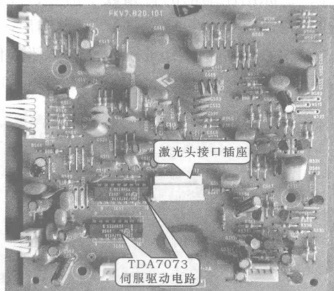
图 1-11 伺服预放电路板的结构
