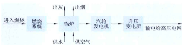
汽轮机发电的生产流程示意图
