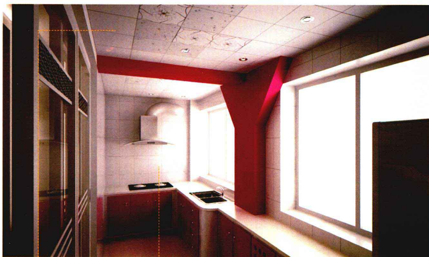
PVC扣板吊顶 釉面砖墙面
