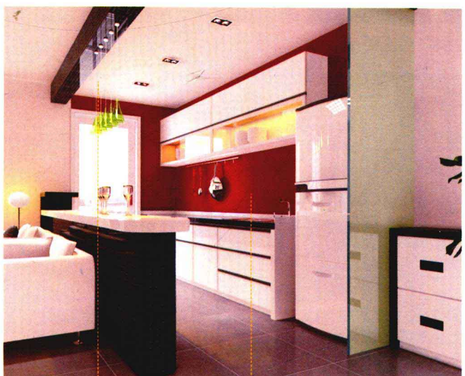
石膏板吊顶 防水乳胶漆
