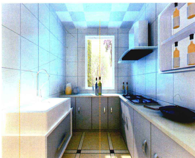
釉面砖墙面 PVC扣板吊顶
