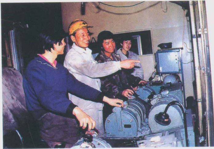
[91] 北京高级工程师陈仲盛（右一）在用铸铁冷焊技术修补机床导轨
