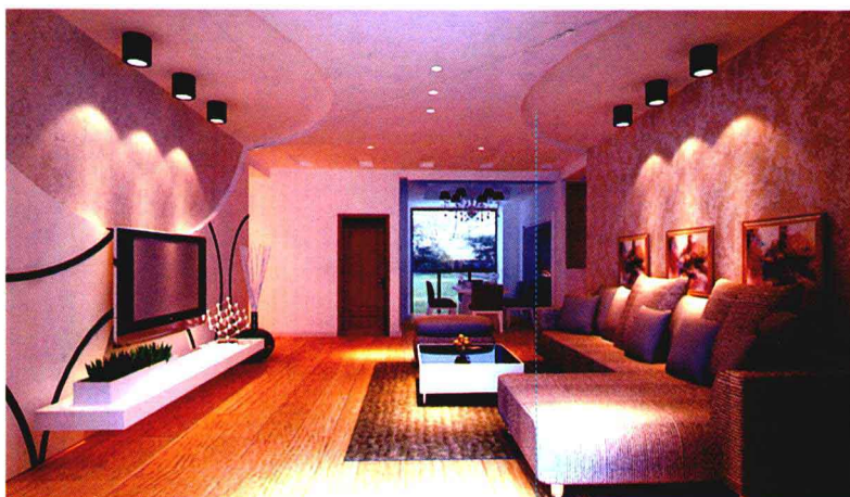
石膏板弧线造型吊凸顶
