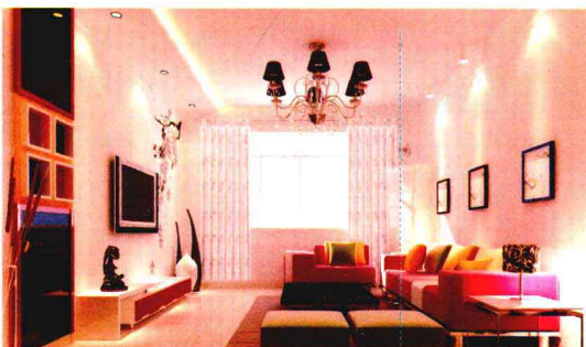
局部石膏板吊顶
