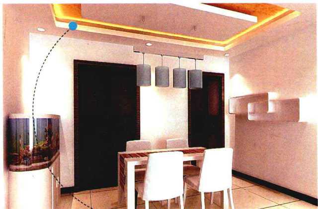
纸面壁纸+石膏板悬吊顶+乳胶漆
