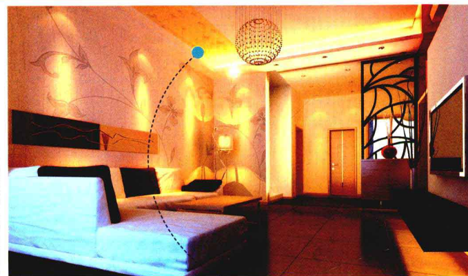
纸面石膏板吊平顶+纸面壁纸
