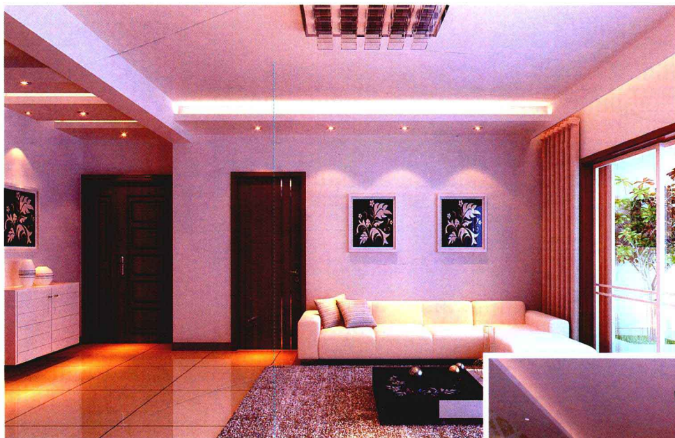
石膏板局部吊顶
