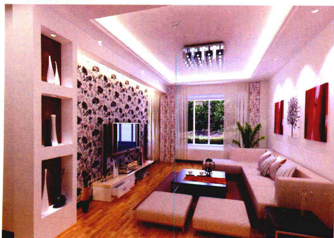
石膏板局部吊顶
