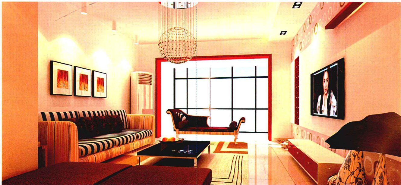
石膏板局部吊顶+筒灯照明
