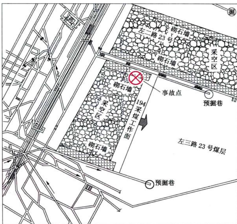
图 1-2 采空区瓦斯燃烧封闭不当引起爆炸示意图
