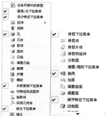
③ 单击【孔】命令,即可实现【孔】命令图标在工具条上的显示与隐藏。
