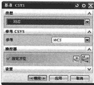
❸ 单击选中立方体的端点，并捕捉一条轴即可建立坐标系。
