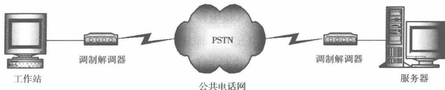
图 2-1 通信系统实例
