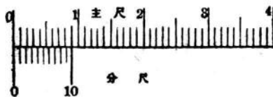
图 9 公制卡尺的制造原理
