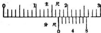
图 8 英制卡尺的使用举例
