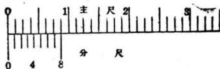
图 7 英制卡尺的制造原理
