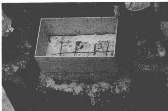
图8 采用含麻丝的石膏浆将上底板与土基体紧密的包围起来
