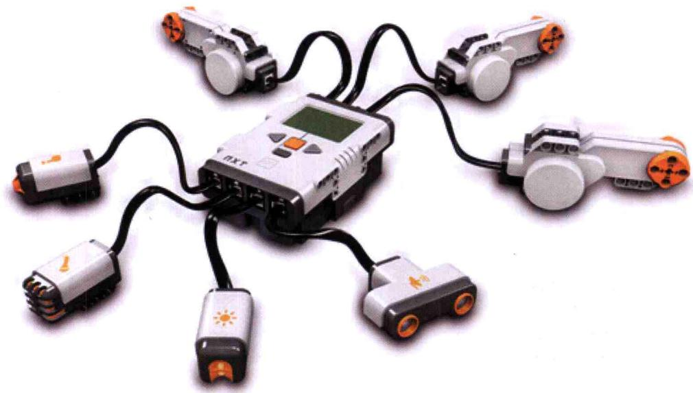
LEGO 9797 蓝牙机器人硬件是由 NXT 控制器、伺服电机（马达）、传感器和 400 多块 LEGO 积木组成。
