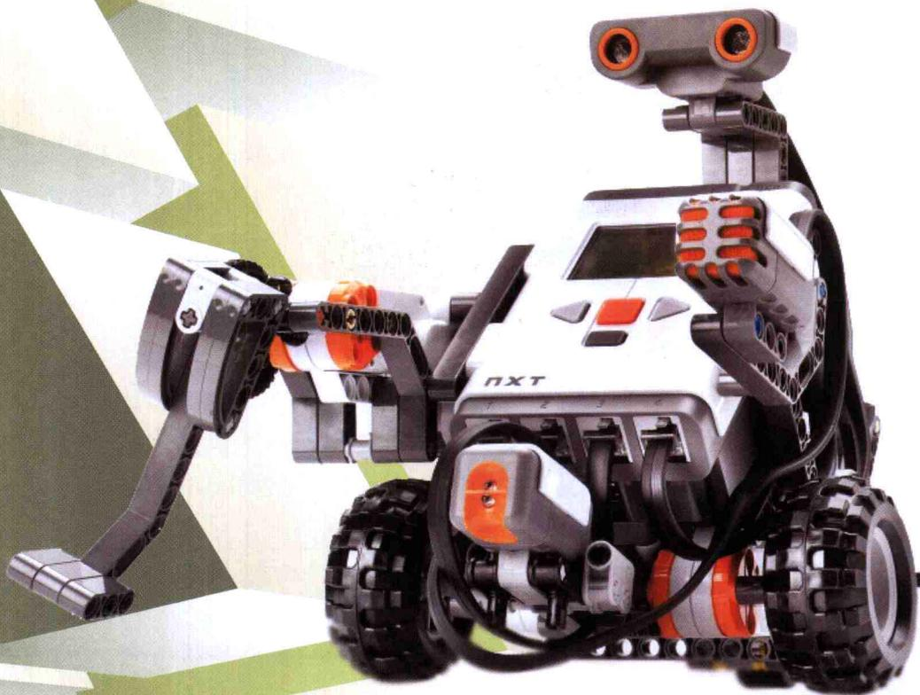
在硬件方面，LEGO 机器人的零件精度高，均采用高质量的 ABS 工程塑料材料制作，精度极高，误差不超过 5 微米，达到了工业工程中高标准级别的质量。零件可反复拼插使用达 1 万次以上，寿命长达 5 年以上，不会受外界温度影响而变形或收缩，具有安全、环保、无毒、耐磨等特点。LEGO 机器人套件的拼插方式非常容易让人们接受。LEGO 机器人套件有两种拼插方式，一种是凸点式拼插方式，一种是结构键拼插方式。不但可拼可拆，拼错可以修改，而且可以仿照搭建步骤进行拼插，也可以自行设计、组装，变化无穷，具有无限延
