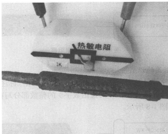
图 1-12 通电加热烙铁靠近热敏电阻器
