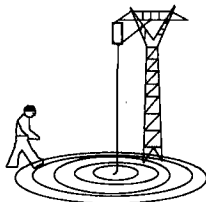
图 1-4 跨步电压触电
