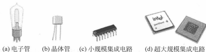
图 1-2 电子管、晶体管与集成电路
