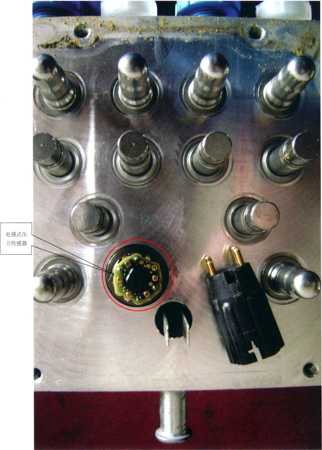
图 1-5 压力传感器作用和结构图
