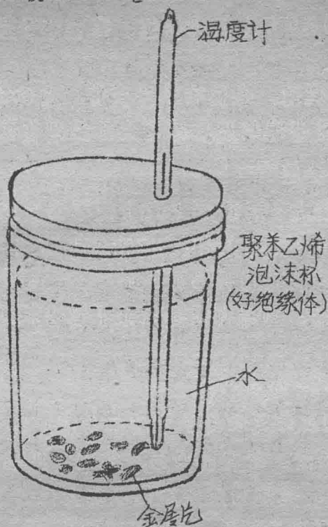
图5 咖啡杯量热器也用于测定溶液中不同物质间的反应热或测定溶解热
