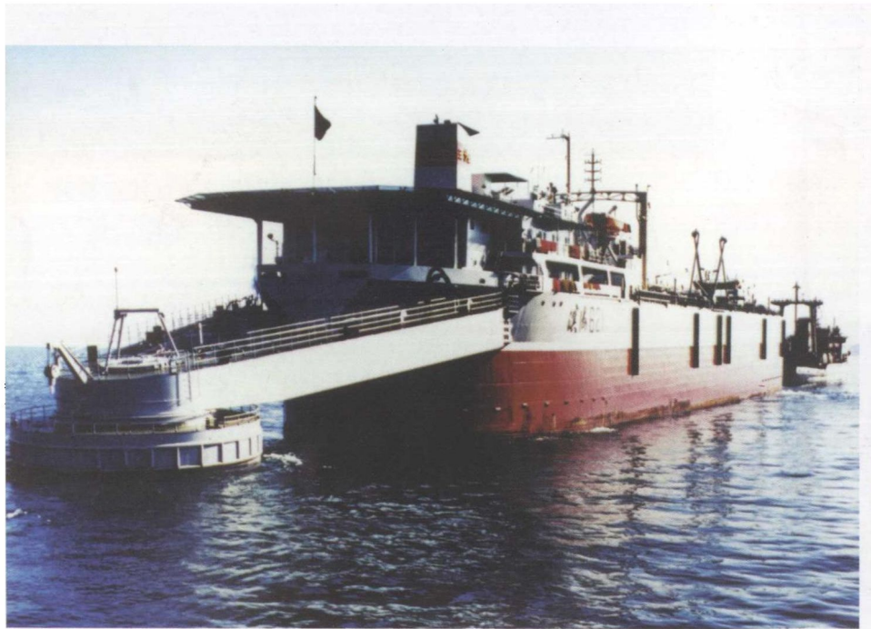
1981年，船舶检验局大连办事处执行建造检验与发证的我国第一艘单点系泊储油船“滨海621”号，25 000总吨。
