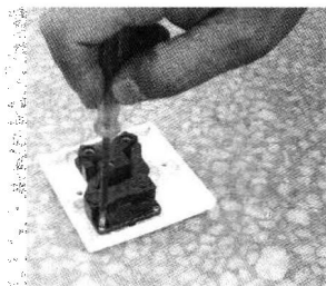
图 1-7 小螺钉旋具的使用方法
