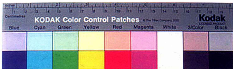
图2-7 色彩控制条可对图像扫描的色彩还原能力进行检测
