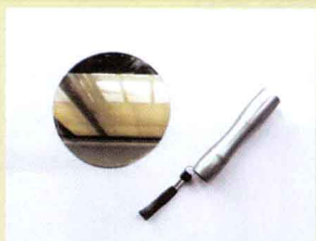
小镜子与手电筒：用于查看隐蔽的构造或细节，也可以用来照明阴暗部位。
