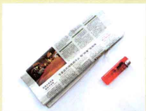
废旧报纸与打火机：用于测试厨房、卫生间烟道和风道是否通畅。
