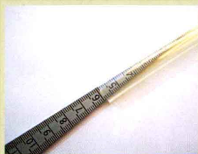
塞尺：用于测量墙面、地面及各种构造中裂缝的宽度。
