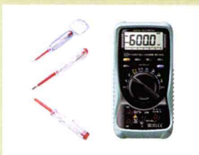
试电笔与万用表：用于测试各强、弱电插座及终端是否畅通。
