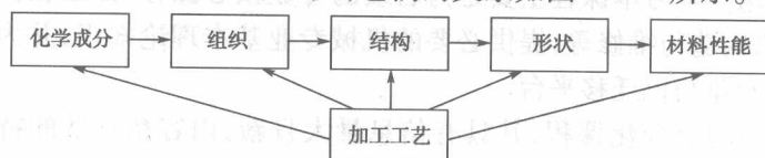
图 1-0-2 影响材料性能的多种因素关系图
