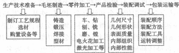
图1-0-1 机械制造的一般过程
