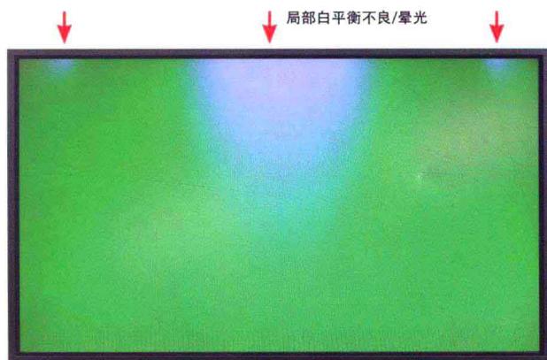
图 12-22 T-CON 故障——局部白平衡不良 / 晕光 1
