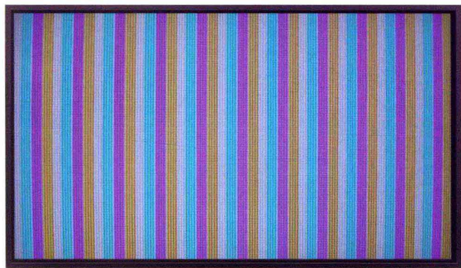
图 12-15 T-CON 故障——重复图案多色垂直条纹 1
