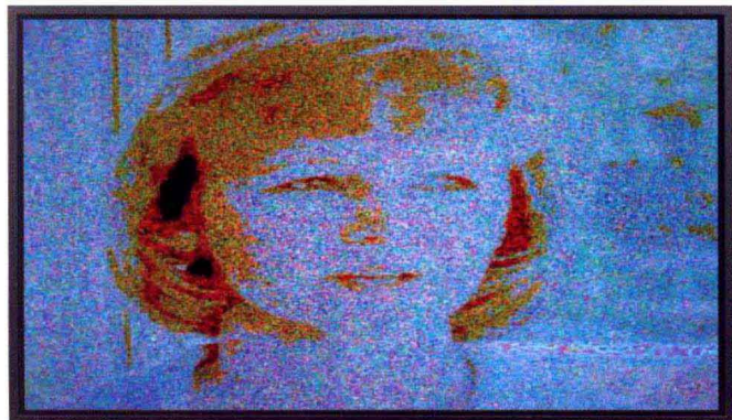
图 12-18 T-CON 故障——负像、颗粒状图像 1
