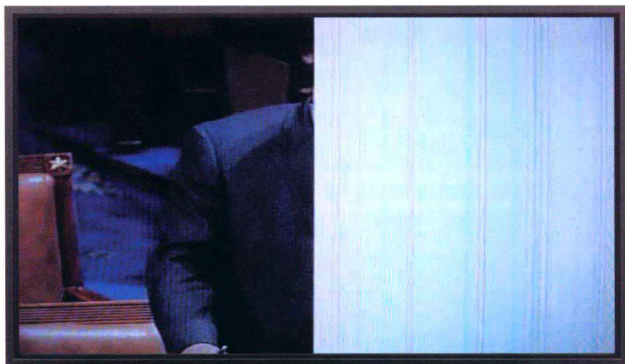
图 12-20 T-CON 故障——半屏正常图像 1
