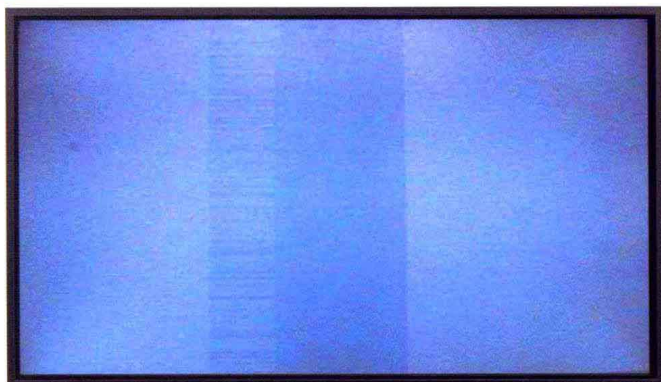
图 12-8 液晶屏上（下）边驱动 IC 或邦定故障引起的垂直带
