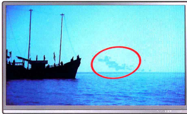
图 1-9 液晶屏受外力损伤产生的轻度液晶像素单元受损现象
