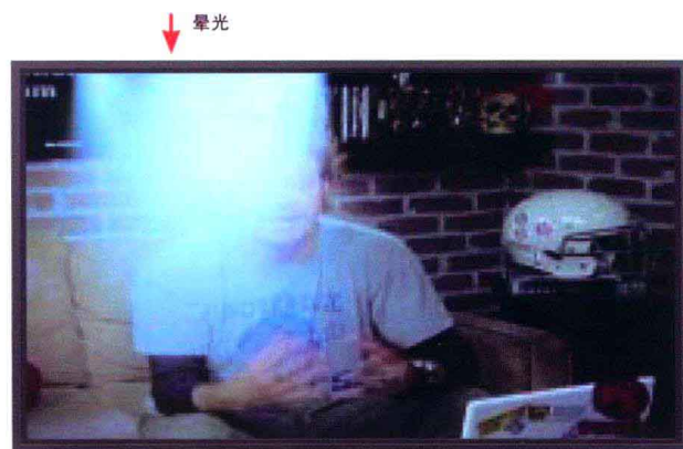
图 12-23 T-CON 故障——局部白平衡不良 / 晕光 2
