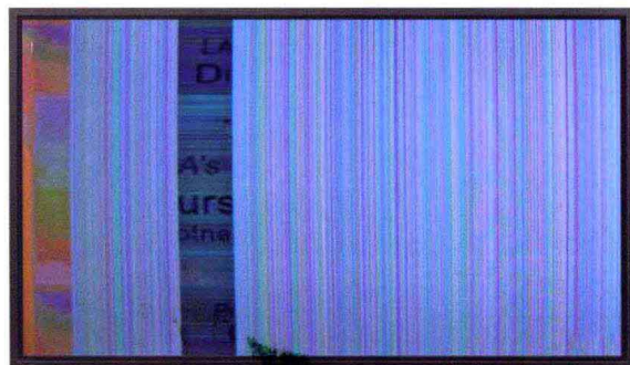
图 12-16 T-CON 故障——重复图案多色垂直条纹 2
