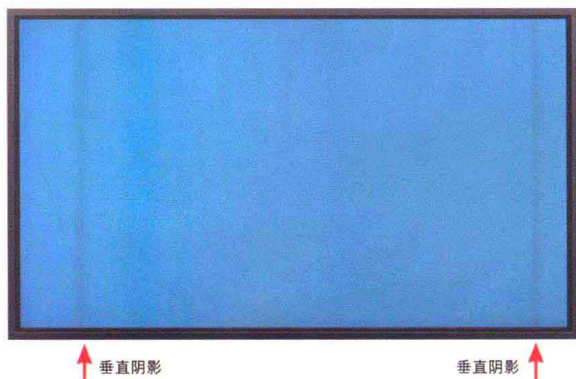
图 12-14 液晶屏垂直阴影故障
