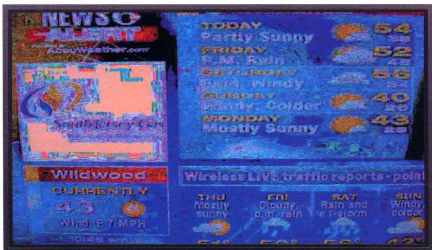
图 12-19 T-CON 故障——负像、颗粒状图像 2
