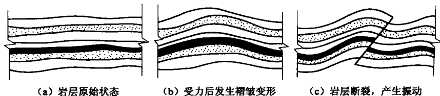
图 1-3 地壳构造变动与地震形成示意图
