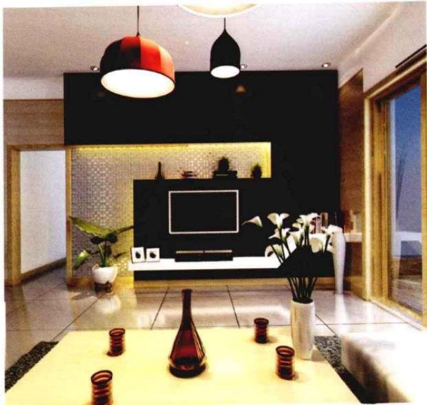
石膏板+马赛克+白色混油，用木龙骨做框架，一部分用石膏板做造型，面层喷涂乳胶漆，一部分用大芯板做造型，白色混油饰面，里层墙面贴马赛克，造价约320元/平方米。
