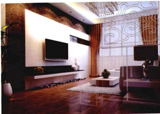
壁纸+石膏板+白色混油，用木龙骨做框架，一部分用石膏板造型面层贴壁纸，一部分用大芯板造型白色混油饰面，里层墙面喷涂乳胶漆，造价约230元/平方米。
