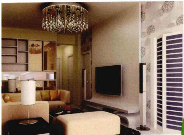
壁纸+白色混油，墙面贴壁纸，并用大芯板做造型，面层喷涂白色混油，造价约290元/平方米。
