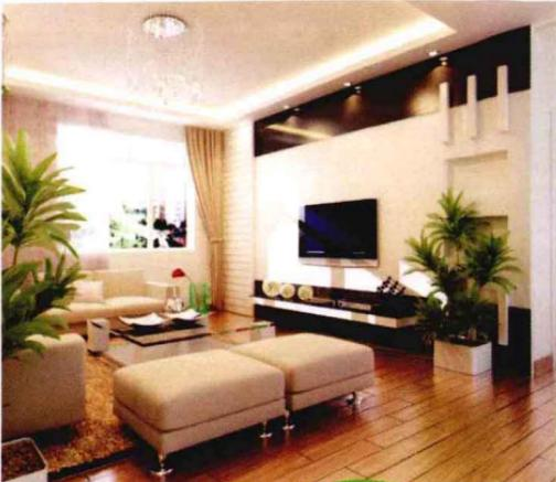
白色混油+烤漆玻璃，墙面一部分干挂烤漆玻璃材，一部分用大芯板做造型，白色混油饰面，造价约220元/平方米。
