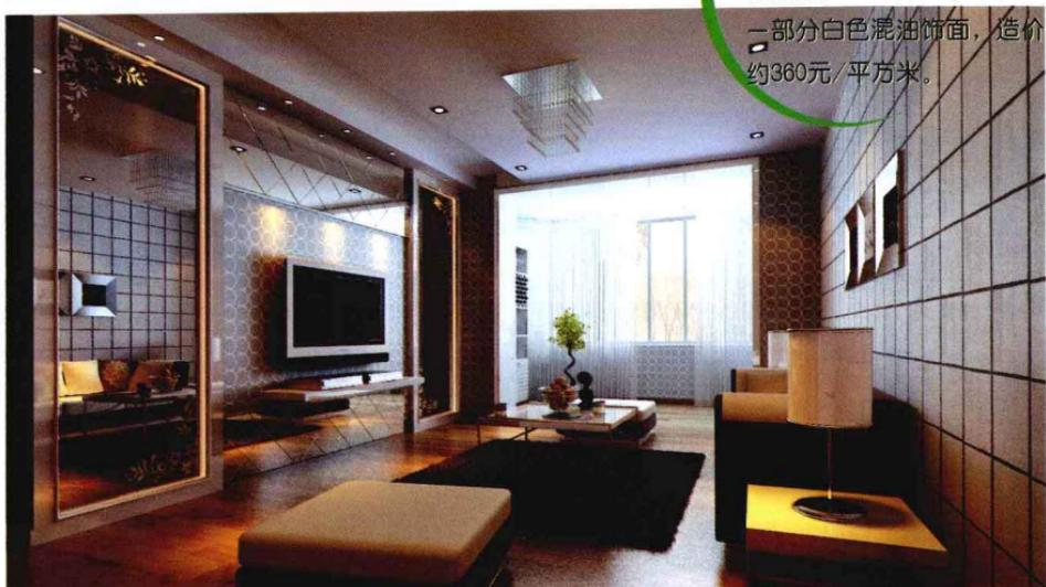
水银镜+白色混油，墙面中间部分干挂水银镜，两侧用木龙骨做框架，大芯板做造型，一部分贴水银镜，一部分白色混油饰面，造价约360元/平方米。
