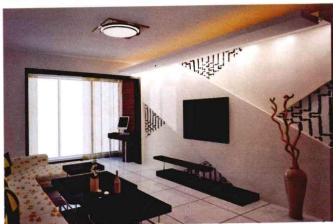
壁纸+白色混油，墙面贴壁纸，并用大芯板做造型，面层喷涂白色混油，造价约320元/平方米。
