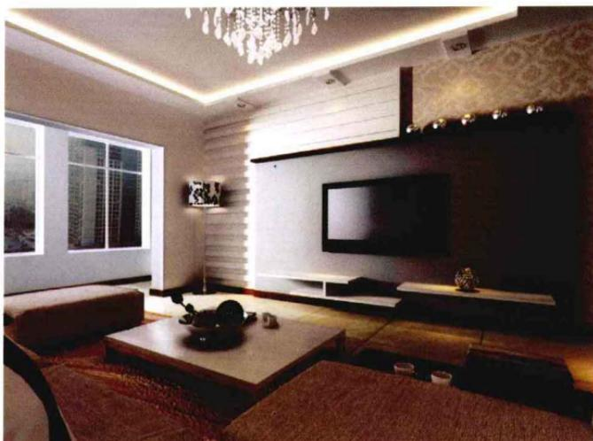
乳胶漆+白色混油+壁纸，中间干挂石材造型，面层喷涂乳胶漆，左侧大芯板造型白混油饰面，右侧贴壁纸，造价约360元/平方米。
