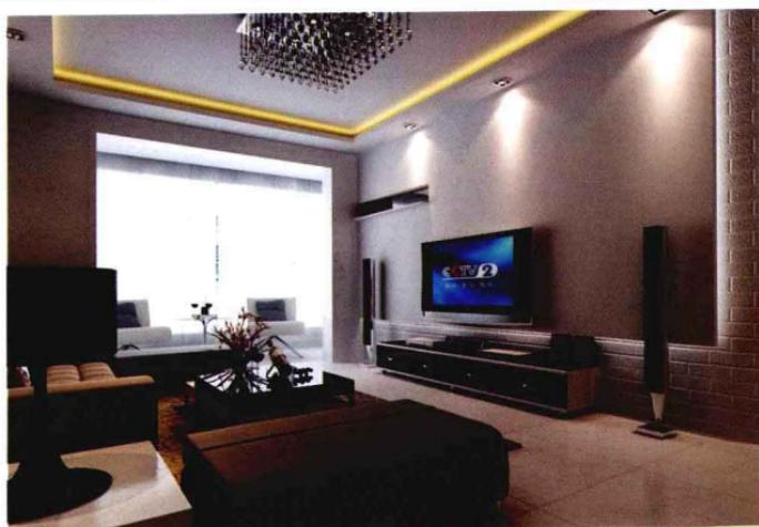
仿砖纹板+白色混油，墙面一部分用木龙骨做框架，大芯板造型，白色混油饰面，一部分贴仿砖纹板，造价约310元/平方米。
