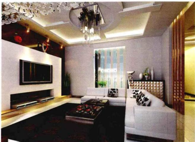
白色混油+烤漆玻璃，墙面一部分干挂烤漆玻璃材，一部分用木龙骨做框架，大芯板做造型，白色混油饰面，造价约260元/平方米。
