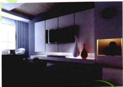
乳胶漆+石膏板+白色混油，一部分干挂石膏板造型面喷涂乳胶漆，一部分用大芯板做造型白色混油饰面，里层墙面喷乳胶漆，造价约270元/平方米。
