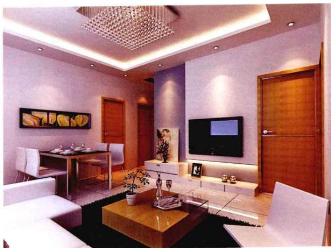
乳胶漆+石膏板+白色混油，一部分干挂石膏板造型，面喷乳胶漆，一部分用大芯板做造型，面喷白色混油，里层墙面喷涂乳胶漆，造价约210元/平方米。
