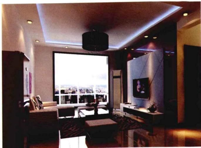
壁纸+白色混油，墙面贴壁纸，然后用大芯板造型，面层喷涂白色混油，造价约270元/平方米。
