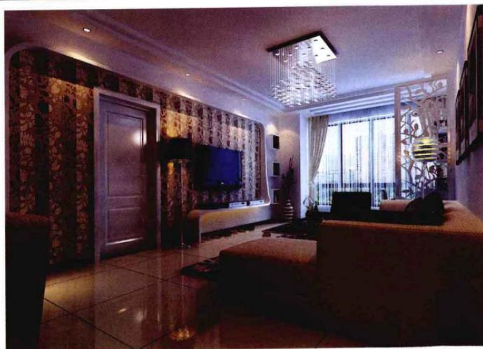
壁纸+白色混油，墙面用大芯板做造型，面层喷涂白色混油，里层贴壁纸，造价约290元/平方米。
