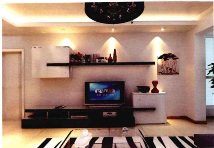
乳胶漆+白色混油，墙面喷涂乳胶漆，后用大芯板做造型，面层喷涂白色混油，造价约290元/平方米。
