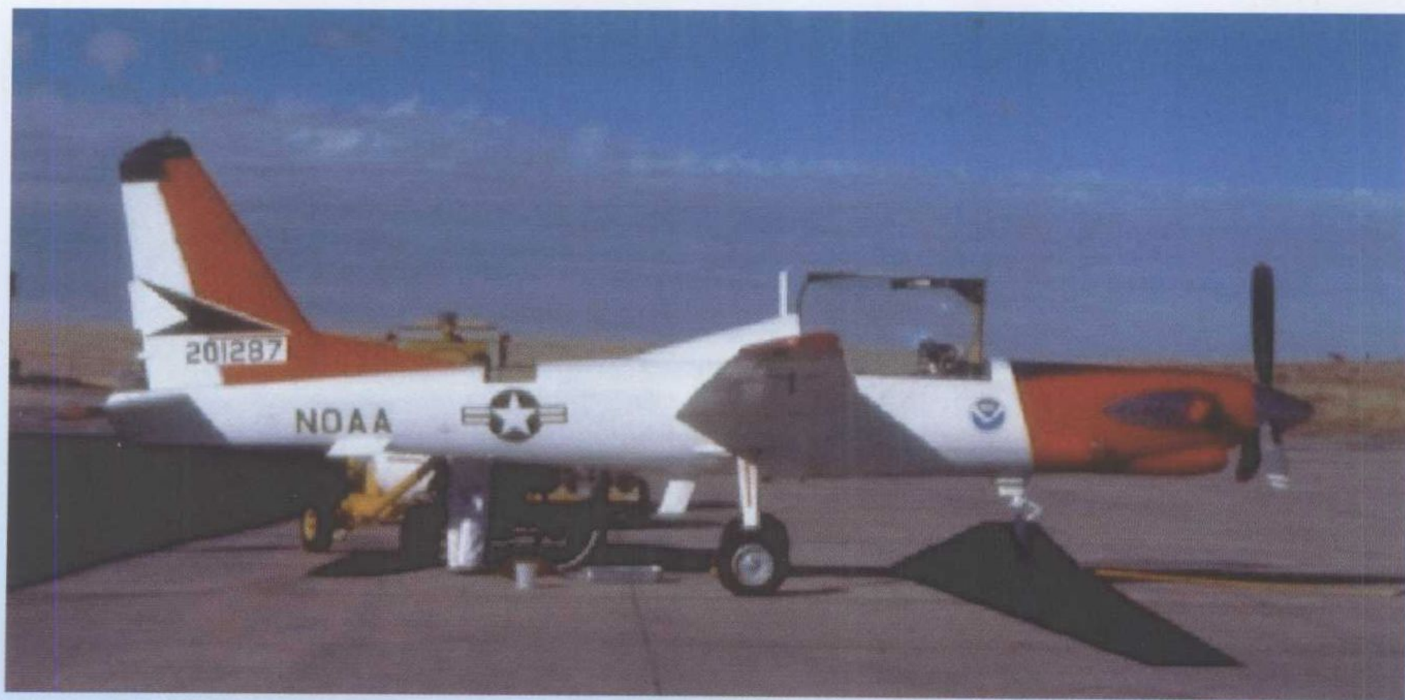
图 1-2 L450F飞机(XQM-93A 的载人机构型)
