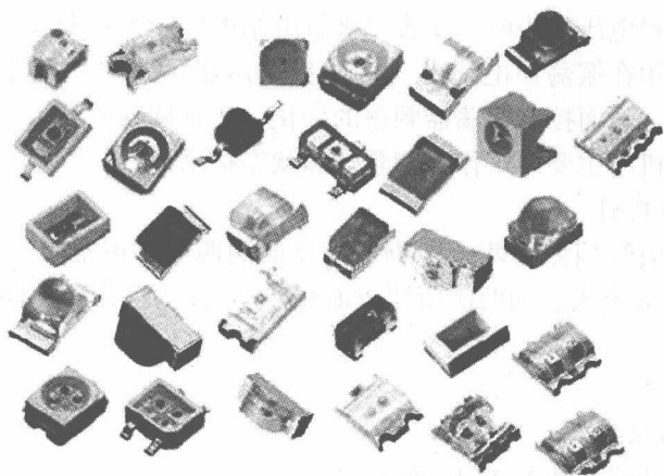
图 1-1-7 贴片发光二极管实物图
