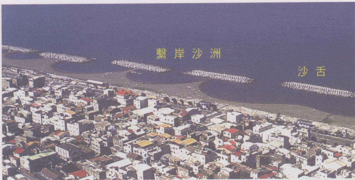
照片9.11 高雄縣茄萣海岸離岸堤之沙舌及繫岸沙洲(經濟部水利處，2000)
