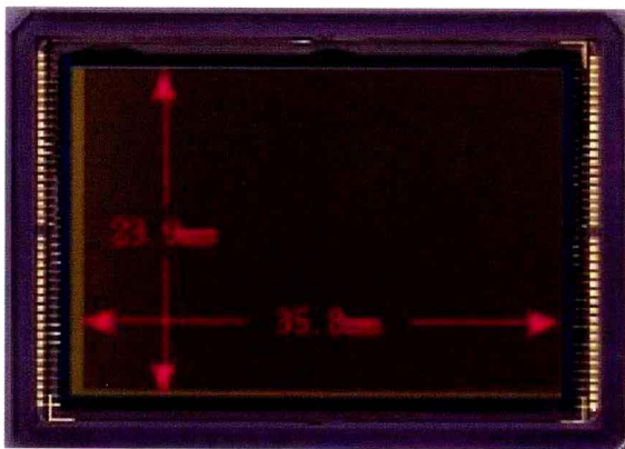
具有与 35mm 胶片同等面积的全幅图像感应器。照片为 EOS 5D 所采用的有效像素为 1280 万像素的 CMOS 图像感应器
