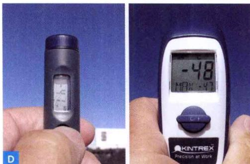
图D：价格较为便宜的Kintrex IRT0401（见左图）及IRT0421（见右图）这两种红外温度计，它们正在测量美国夏威夷冒内罗亚测试点上空那些微量的水蒸气对地面的红外辐射。有时候空气太干燥，以至于两个红外温度计不能测到什么数值。
