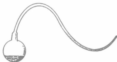
圖1-4：巴斯德瓶。曲頸彎處為塵埃沈澱的位置。
