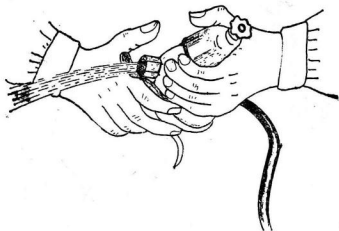
图1-28 用简单方法试验汽油泵输出压力
