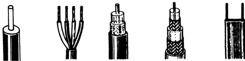
(a) 單心線 (b) 多股線 (c) 同軸線 (d) 多層同軸線 (e) 平行線
