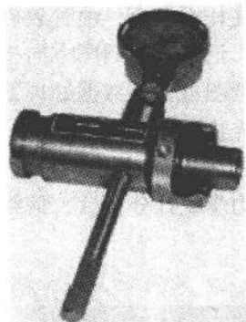
图 2-2 SY-40B 微表式单体 液压支柱测力计
